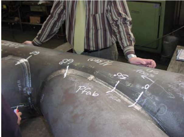
Bild 4.2.1: Prüfknoten für Verfahrensprüfung
