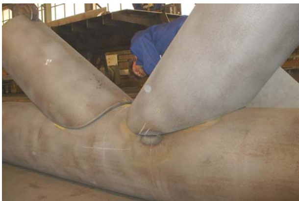
Bild 3.1.2 und 3.1.3: Nahtvorbereitung Versuchsknoten
